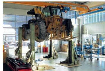
Selbst größte Baumaschinen können mit der mobilen Hebebühne angehoben werden.
